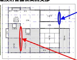
旧友井家を題材に、仕口ダンパーで制震性能を向上。 大地震に対して、倒壊することなく、再利用可能な程度 に損傷を止める提案。乾式の荒壁パネルを用い、景 観・使い勝手とも従来と変わらない。
