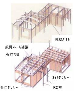
【使用した工法】 ・仕口ダンパー ・オイルダンパー ・荒壁パネル
