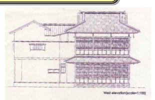
阪神・淡路大震災で倒壊した谷崎潤一郎旧邸「鎖 瀾閣」を題材。大地震に対しては荒壁パネルと仕 ロダンパーにより倒壊することなく、さらに、オイル ダンパーにより再利用可能な程度に損傷を止める。
