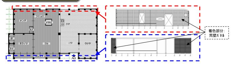
旧井上家を題材に、荒壁と同等以上の耐震性を有する荒壁パネルを下地とし、 既存の荒壁を再利用し、環境面にも配慮。伝統民家のよさをそのまま残す。
